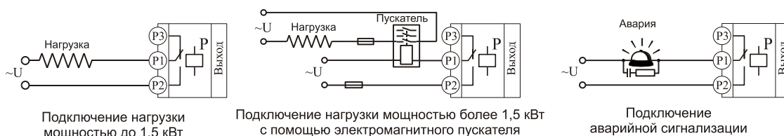
Рисунок 3 - Использование релейного выхода
